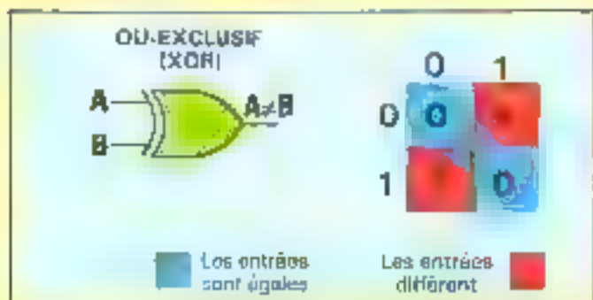
Fig. 4 - Le circuit comparateur par excellence, le OU-EXCLUSIF. C'est la fonction « différent de » (uniquement si les entrées sont « égales »).
